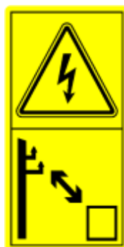
Рис.10 – аппликация БП 1000.800.805 «Сохраняйте дистанцию от линий электропередач»
